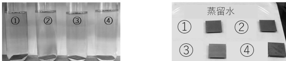
図4 蒸留水を用いたとき (左:水溶液の様子、右:銅板表面の様子)
