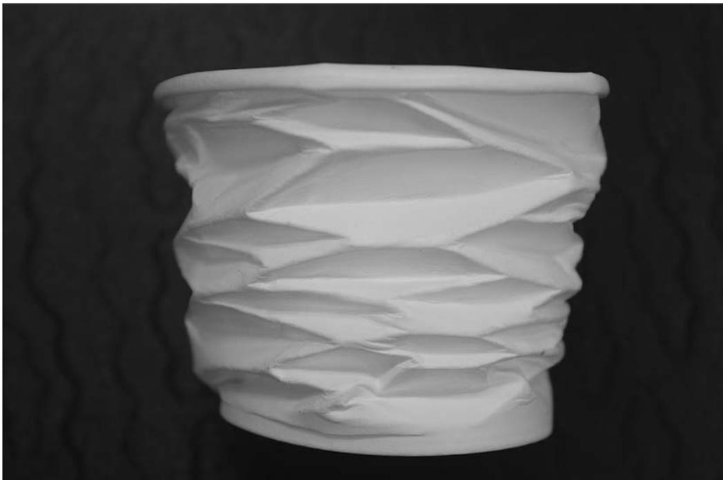
写真1：紙コップを上下方向に圧縮することにより生じた「青野パターン」。圧縮軸の方向に対して垂直な方向に細長く伸びた六角形が連続したパターンが生じ、菱形にトランスフォームする部分も見られる。
