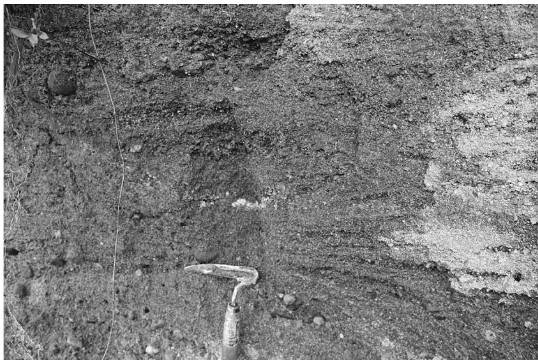
写真8：大針露頭における軽石層（Pm-III）を含む斜交葉理
