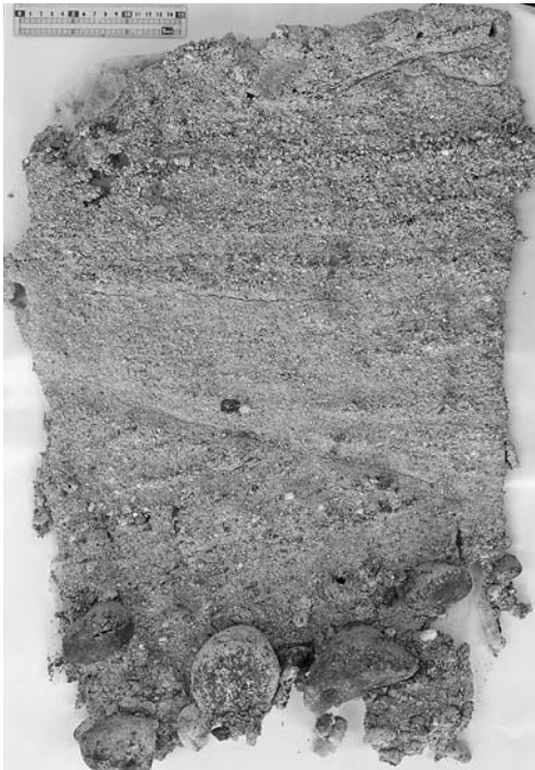
写真15：「トマック ns-10」と裏地に寒冷紗を用いた 斜交葉理の固定サンプル
