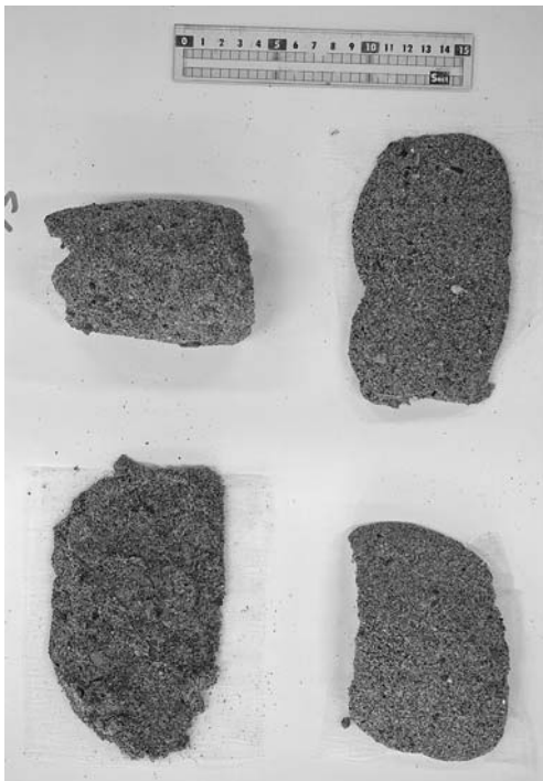
写真11：「トマック ns-10」を用いた砂の固定 (寒冷紗表面)
