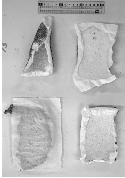
写真14：「トマック ns-10」を用いた砂の固定 (ガーゼ裏面)
