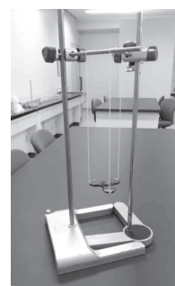
図8 慣性モーメントの測定の様子
